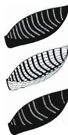
Sistemas de reconstrucción: de "concha", de "esqueleto" y mixto, según O. Höckmann, Antike Seefahrt , Munich, 1985, figs. 38-40.
