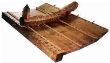
Reconstrucción del sistema de ensamblaje de barco IX del puerto de Marsella, según P. Pomey, La navigation dans l'Antiquité , Aix-en-Provence, 1997, p. 92.
