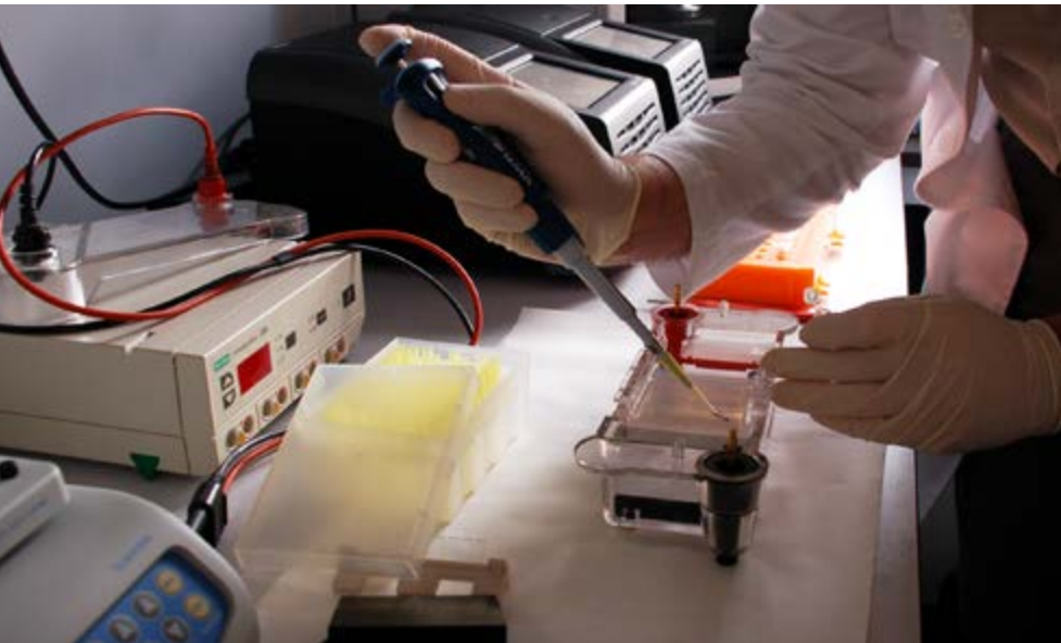
Separación de fragmentos amplificados de ADN mediante electroforesis en gel de agarosa (Laboratorio de Biología molecular del Instituto Canario de Bioantropología). Esta técnica permite separar fragmentos de ADN según su tamaño en presencia de un campo eléctrico. El ADN, con carga negativa, migra hacia el polo positivo, más rápidamente los fragmentos pequeños y con más lentitud los fragmentos mayores. Fotografía: Instituto Canario de Bioantropología.
